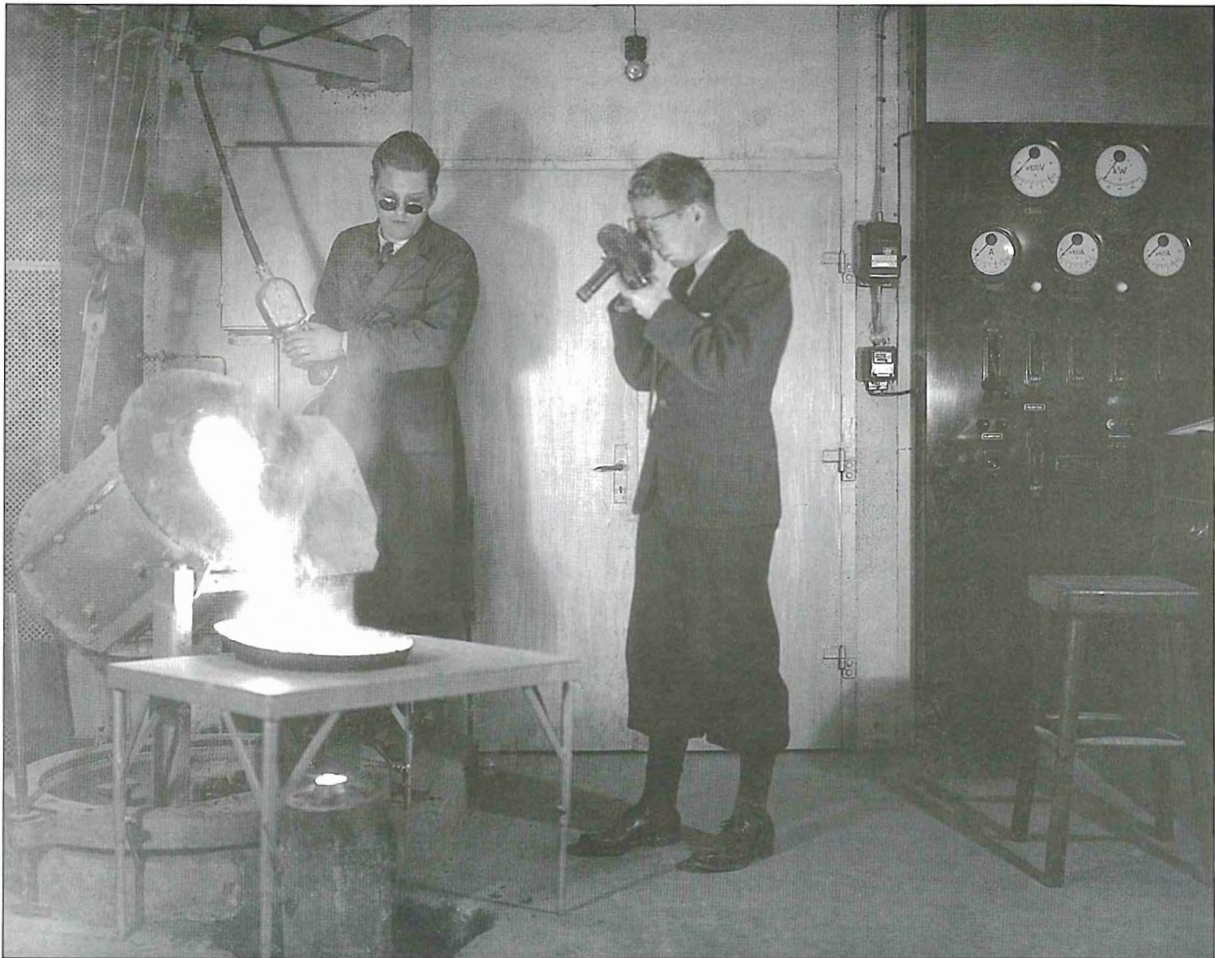
Uddeholm tog tidigt forskningen till sin hjälp. Här en högfrequensexperimentugn vid Hagfors järnverk. Foto: Edvin Fornander, 1940. Ur Edvin Fornanders samling, volym K I:19.
